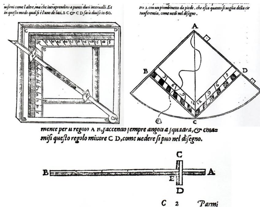
**Figura 1:** Da esquerda para a direita temos o quadrante geométrico e o quadrante num quarto de círculo e, abaixo, o báculo (BARTOLI, 1564, p. 3r, 8r e 10r)
