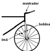
Figura 11. Velocímetro digital.
