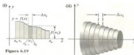
Nota-se que o k<sup>mo</sup> retângulo gera um **disco circular** (um cilindro circular) de raio da base f(w)<sub>k</sub> e altura (espessura) Δx<sub>k</sub>=x<sup>k</sup>-x<sub>k-1</sub>. O volume deste disco, é área da base vezes altura. Isto é π[f(w)]<sup>2</sup>Δx<sub>k</sub>. O volume do sólido da Figura 6.19(ii), é a soma [obtida pela adição] de volumes de todos esses discos. Isto é,
