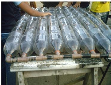
PET poderiam ter sido feitas com maior área e ter acompanhado a curvatura interna das garrafas, para absorver mais energia solar e transferi-la para a água em forma de calor.
